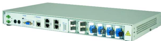
Рис. 3. Компактный центральный узел GPON малой плотности (4 сегмента PON)
