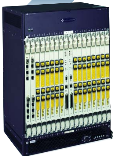
Рис. 2. Типичное оборудование GPON/EPON – центральный узел OLT, абонентское устройство ONT для установки в помещении, абонентское устройство ONT для внешней установки
