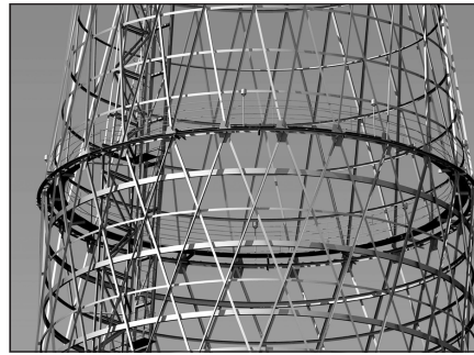
Рис. 5. Фрагменты твердотельной модели башни
