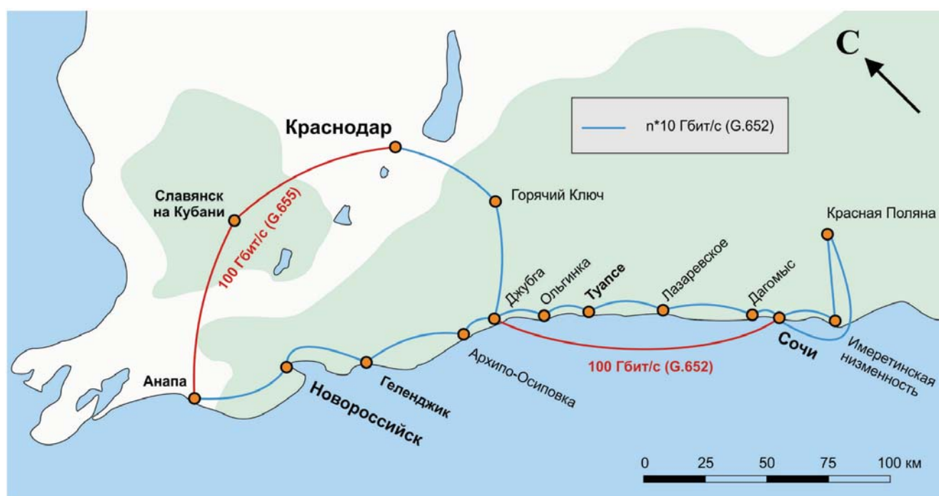
Рис. 1. Общая схема сети DWDM в Краснодарском крае
