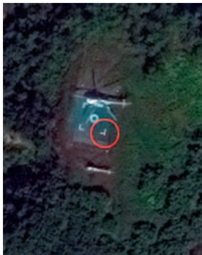
Рис. 1. Точка P001. Верхняя вертолётная площадка (на пригорке рядом с кордоном). Юго-восточный угол контрастной разметки, нанесённый краской на металл. Внешнее острие угла
