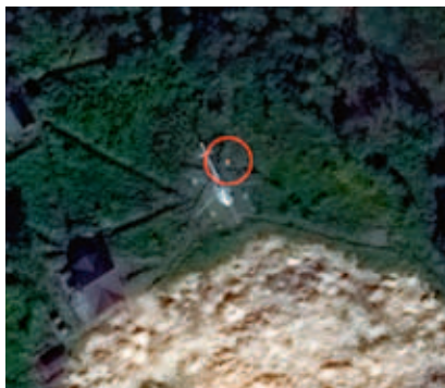
Рис. 3. Точка Р003. Нижняя вертолётная площадка. Северный угол контрастной разметки, нанесённый краской на металл. Внешнее острие угла
