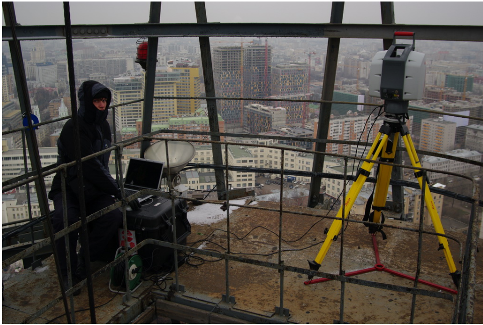
Рис. 2. Выполнение лазерного сканирования, отметка 125 м, 2011 г.
