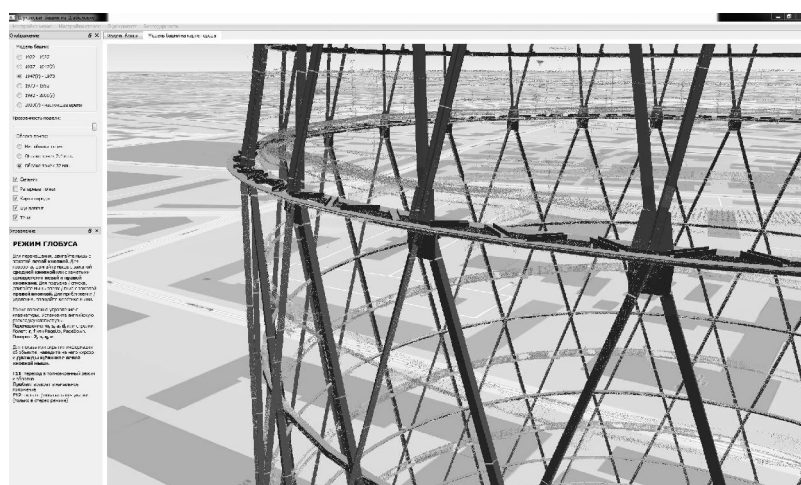
Илл. 3. Совмещение трёхмерной точечной модели и трёхмерной полигональной модели Шаболовской радиобашни с привязкой к карте города [3].
