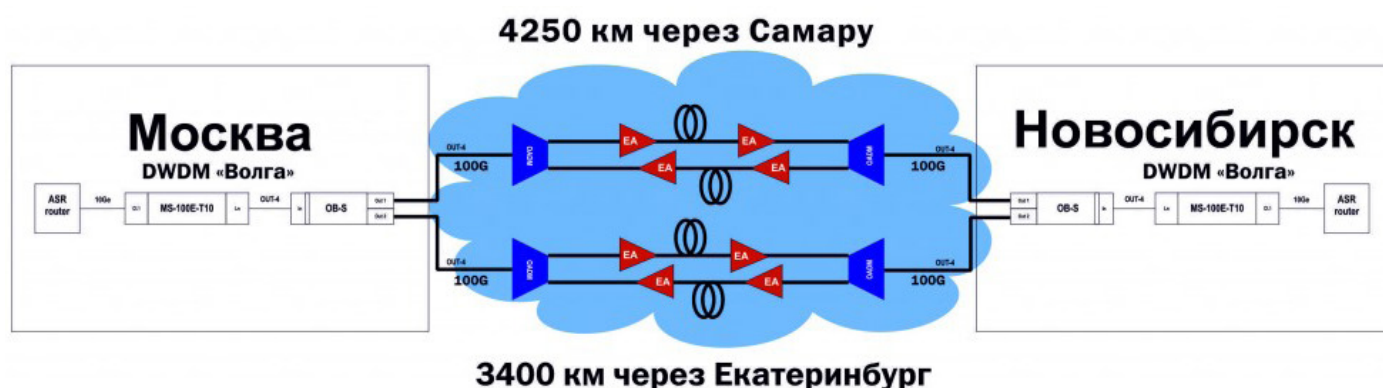
Рис. 5. Схема рекордной линии Москва-Новосибирск без регенерации сигнала (2015).
