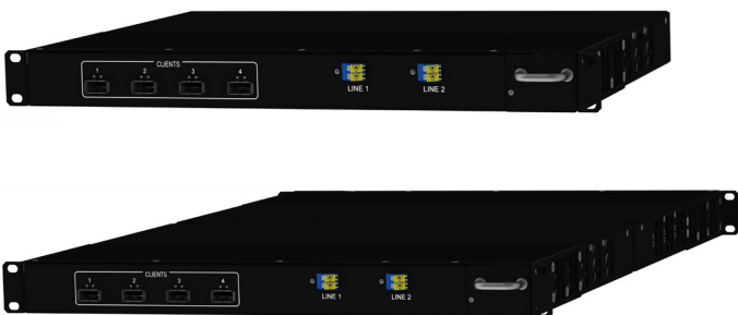
Рис. 3. Система «200G по одной несущей» производства «Т8». Ёмкость 400 Гбит/с при глубине 300 мм (вверху) или 800 Гбит/с при глубине 600 мм (монтаж «спина к спине», внизу).
