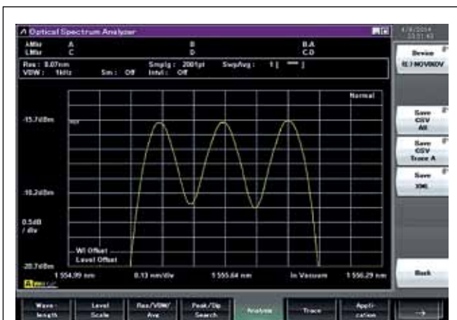
Рис.3. Спектр суперканала 3 \times 100G в сетке 100 ГГц
